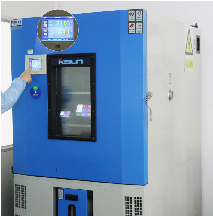
图 5-7 高低温老化测试图
